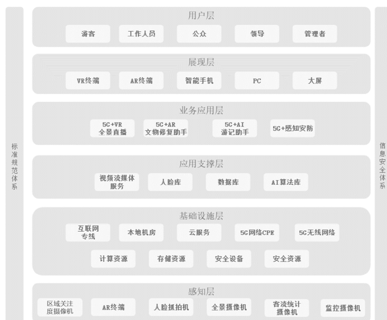
图 3 南海博物馆 5G 专网应用架构图
