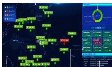
分布式光纤温度、振动、应力变化监测
