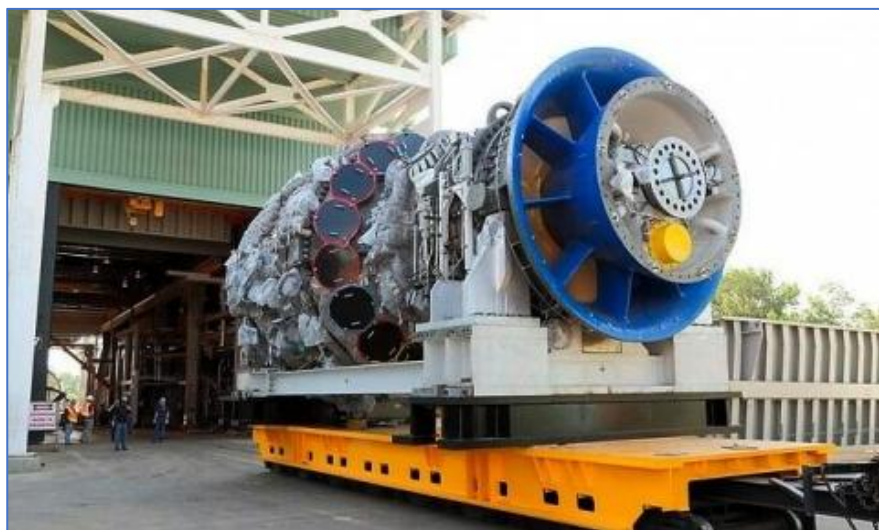
大型设备AGV搬运
