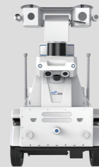
变电站巡检机器人
