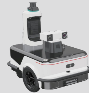
变电站巡检机器人
