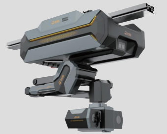
皮带巡检机器人
