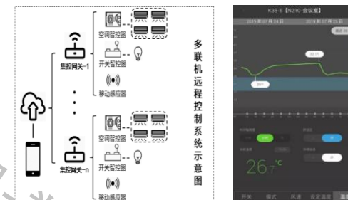
会议室/走廊等非 常驻区域的空调 照明自动控制
