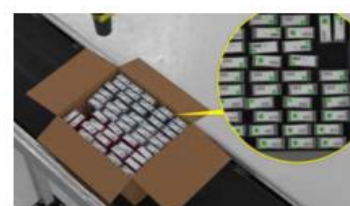
相机系统读取装箱后的条烟上的二维码，以验证箱内产品是否完整，并为外箱创建唯一的序列代码。
