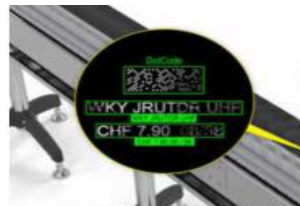
利用相机读取烟包上的二维码和OCR字符，以便在整个供应链中追踪和追溯产品。
