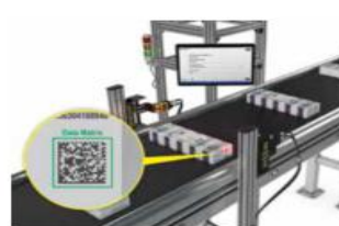
相机可读取高速分拣配送线上条烟上的二维码，以提高产线运转速率并消除误差。
