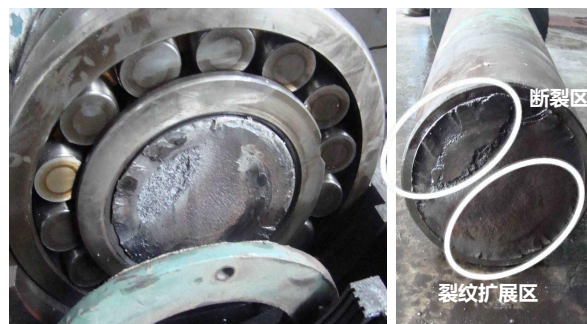
轴裂纹引起轴断裂
